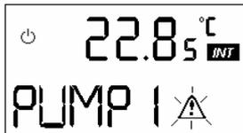
Aparece la indicación PUMP 1 y el triángulo de averías parpadea.
