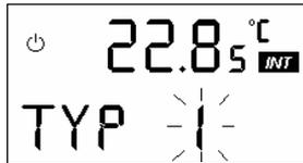
Si se opta por seleccionar un rango de corriente, a continuación se pregunta si se desea emplear el rango de 0 a 20 mA o el de 4 a 20 mA.
