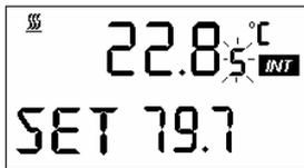
Indicación de la temperatura actual del baño (arriba, con una resolución de 0,05 °C) y del valor nominal (abajo). La bomba se pone en funcionamiento. Se aplican los valores que estaban activos antes de la desconexión.
