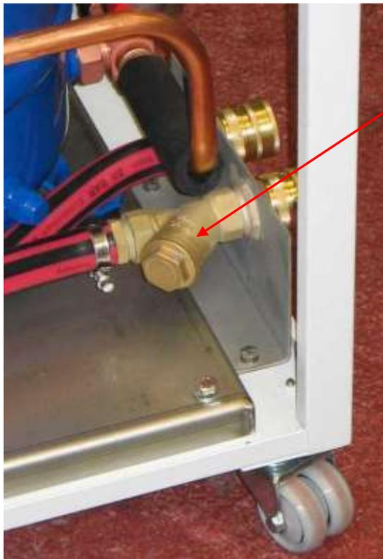
Desatornillar la chapa de revestimiento del lado derecho. Abrir la carcasa del filtro, p. ej., con una llave de boca (SW 19 o SW 27), sacar el filtro de alambre, limpiarlo e insertarlo de nuevo en la entrada de agua de refrigeración. Enroscar la tapa. Colocar la chapa de revestimiento.
