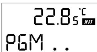
Al presionar la tecla se accede al submenú de las funciones del programador.
